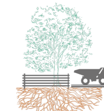
Protection du sol par une piste de chantier
