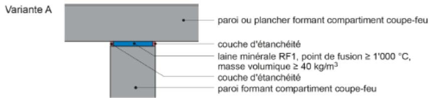
Raccordement d'éléments de construction formant compartiment coupe-feu à des parois extérieures (chiffre 3.3.3, alinéa 2)
