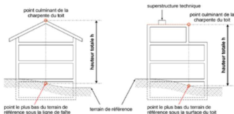
Les superstructures techniques, par exemple celles concernant les ascenseurs, les escaliers, les ventilations, les conduits de fumée ou les installations solaires peuvent dépasser le point culminant de la toiture. Les dispositions de l'Accord
