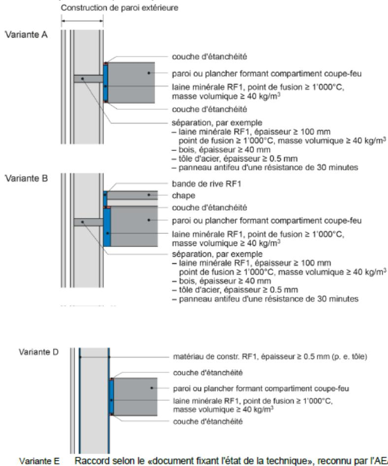
Raccordement d'éléments de construction formant compartiment coupe-feu à la toiture (chiffre 3.3.3, alinéa 2)
